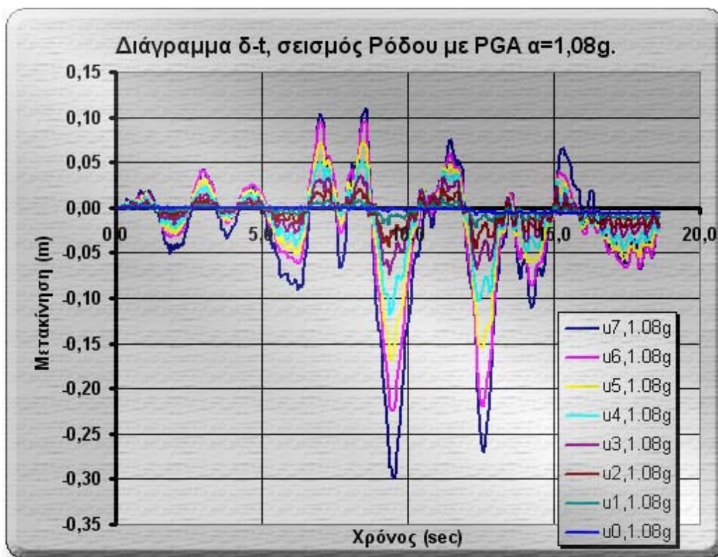
Σχήμα 7-8: Διάγραμμα δ-t μοντέλου E με 7 σπονδύλους και σεισμό πλάτους 1,08g.
