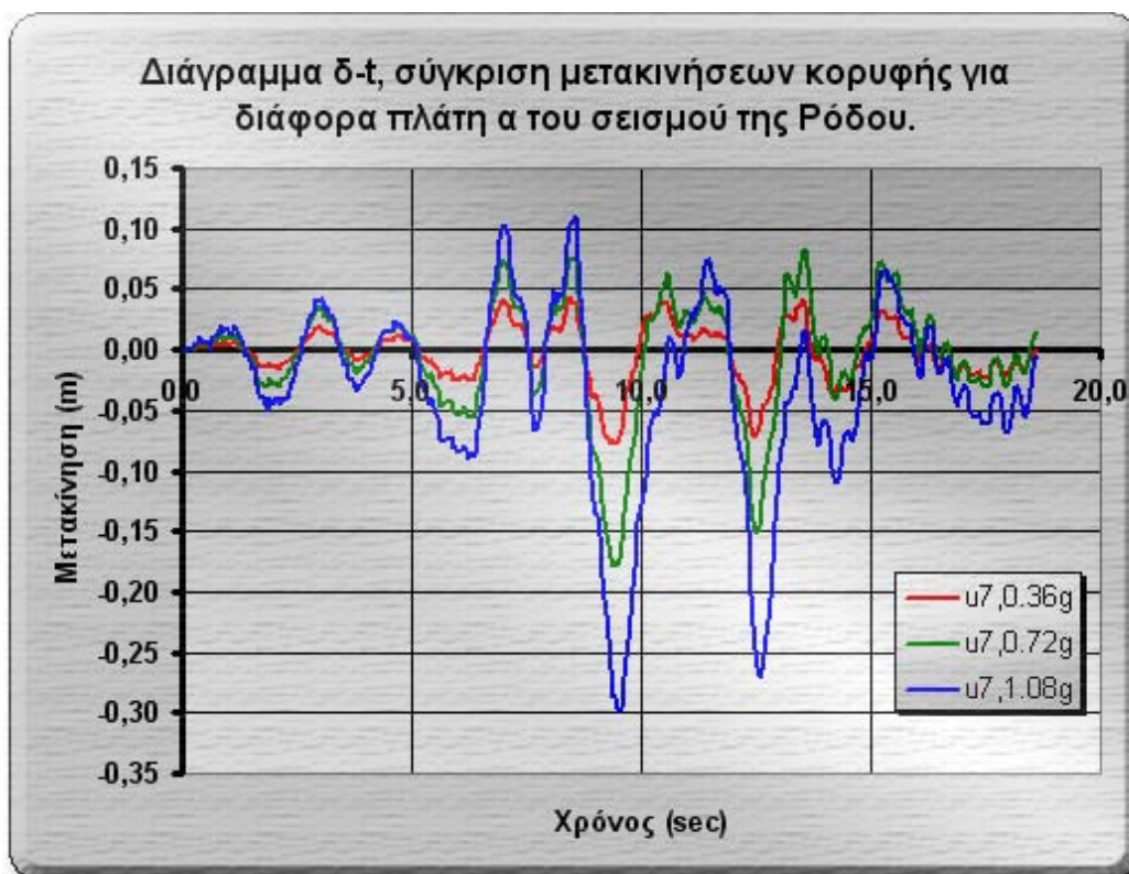
Σχήμα 7-9: Σύγκριση δ-t μοντέλου E με 7 σπονδύλους και σεισμό με διάφορα πλάτη.
